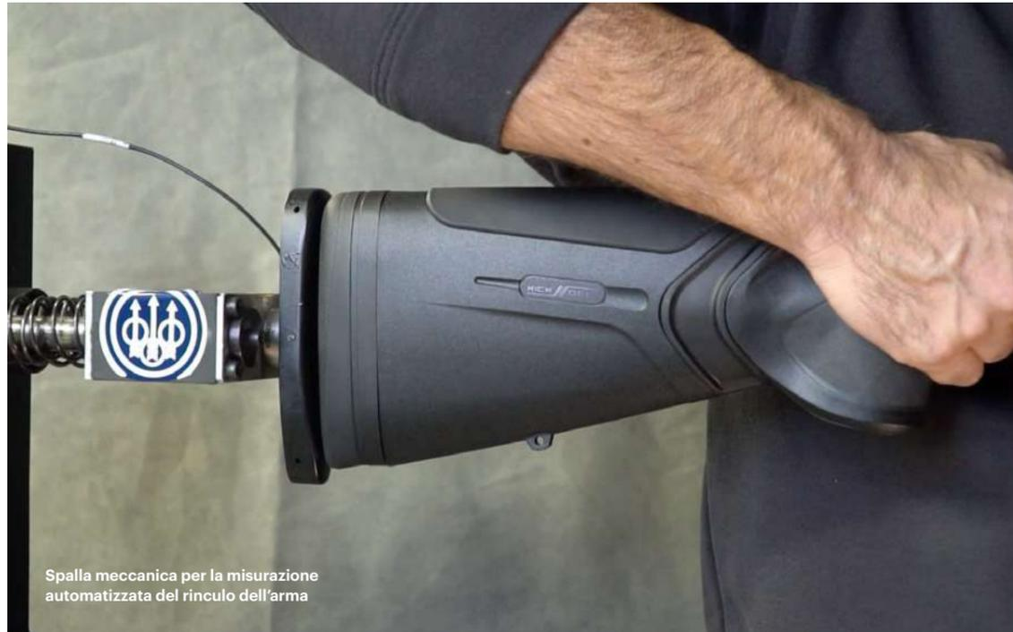
Spalla meccanica per la misurazione automatizzata del rinculo dell'arma
